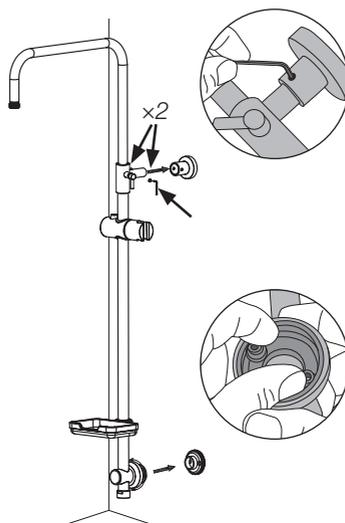
7. Skru løs det øvre veggfestets 2 låseskruer med medfølgende inseksnøkkel, og ta veggfestet bort fra stangen.
