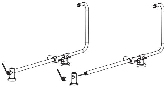
4. Skyv såpeholderen inn på stangen. Fukt dusjstangen og såpeholderen med litt vann, da er det lettere å skyve holderen på plass.
