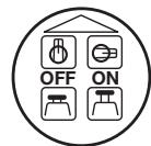
Älä sammuta kompressoria päävirtakytkimestä tai irrottamalla pistoke pistorasiasta. Sammuta kompressor aina ON/OFF-painikkeella.
