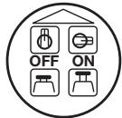
Zum Abschalten des Kompressors niemals den Stecker ziehen oder einen eventuell vorhandenen Hauptschalter ausschalten. Dazu ist immer der ON/OFF-Schalter am Kompressor zu verwenden.
