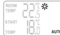
*Ex.2: Programmering av en kylfläkt som slår till vid 20 °C och stängs av när temperaturen sjunkit ner till 16 °C.*
