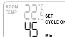
2. Aseta kuinka pitkään lämpötilavahti on päällä (1 min - 24 t) painamalla [+] tai [-]. Vahvasta painamalla [CD]. "SET CYCLE OFF" alkaa vilkkua.
