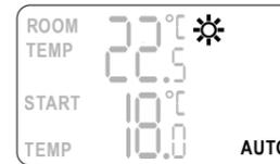
*Eks. 2: Programmering av en kjølevifte som skruer seg på ved 20 °C og skruer seg av når temperaturen har sunket til 16 °C.*
