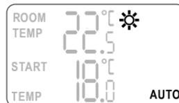
*Esim. 2: Miten ohjelmoida jäähdytin, joka käynnistyy 20 °C:ssa ja sammuu, kun lämpötila on laskenut 16 °C:een.*
