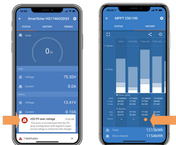
VictronConnect: skärmdump av ett fel #33 och en skärmdump av historiken som visar ett fel
